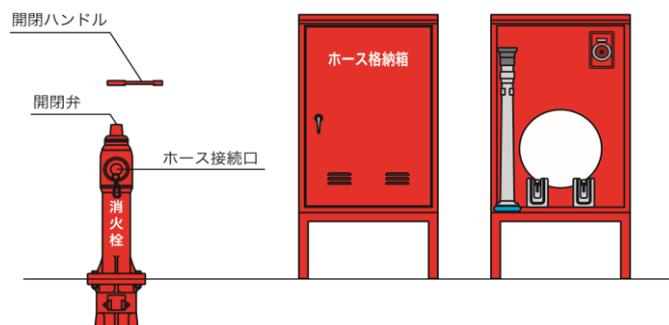
(屋外消火栓箱の内部に開閉弁及びホース接続口を収納して設置する場合の例)
